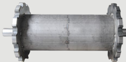
Antriebswelle mit gehärteten Kettenrädern
