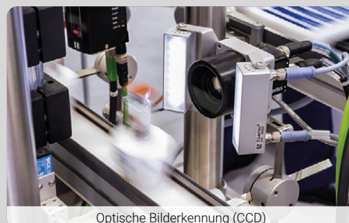
Optische Bilderkennung (CCD)
