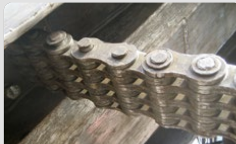
Massive Beschädigungen an den Bolzen und Unterlegscheiben bereits nach 3 Monaten
