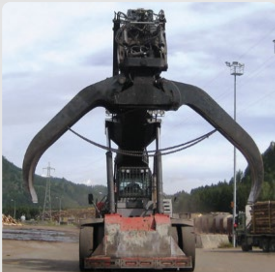
FB Niederhalterketten zur sicheren Fixierung der Stämme
