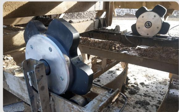
7.000 Liter jährliche Öleinsparung und eine Amortisationszeit von ca. 3 Monaten durch Nachrüstung des RotaLube® Schmiersystems in einem Brückenkratzer
