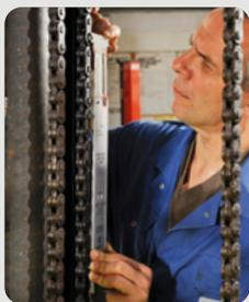
Flyerketten und Rollenketten müssen ersetzt werden, wenn sich die Ketten um 2-3% gelängt haben. Sie können dann nicht mehr betriebs-sicher eingesetzt werden, da die Dauerfestigkeit und Mindestbruchkraft ab diesem Verschleißwert sehr stark reduziert ist. Ab 3% Längenverschleiß müssen Flyer- und
